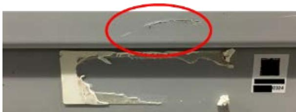
写真 4-1-5. H27 実証結果 上からの衝突落下例（赤丸部に新しい傷）
