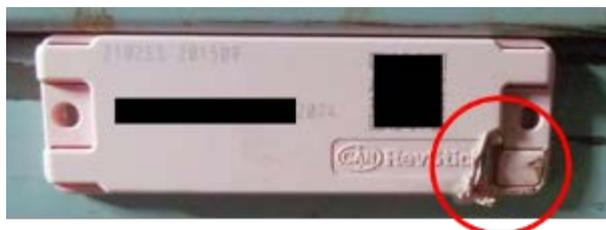
写真 4-1-6. H27 実証結果 横からの衝突例（赤丸部に衝突跡）
