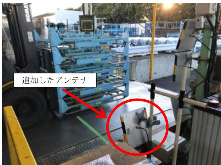
写真 4-2-8. 並列に設置したアンテナ
