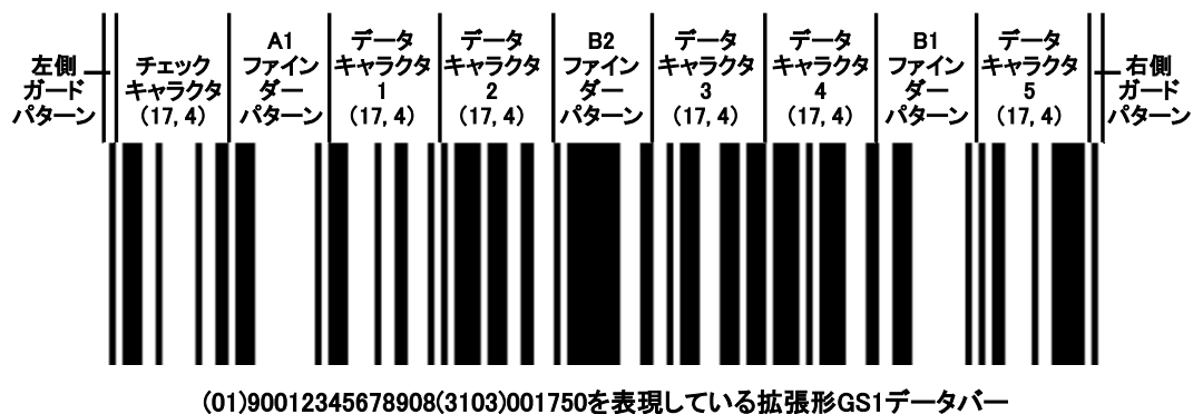
図 2-14-1 拡張形 GS1 データバーの構成例
