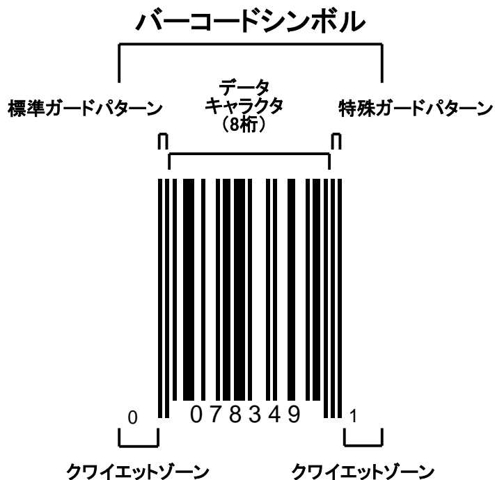
図 2-8 UPC-E の構成例
