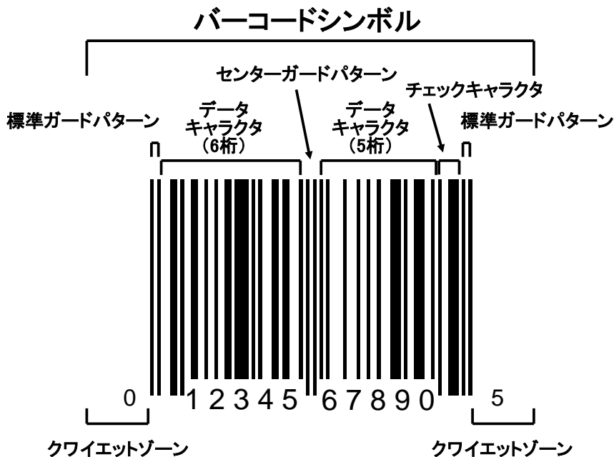
図 2-7 UPC-A の構成例
