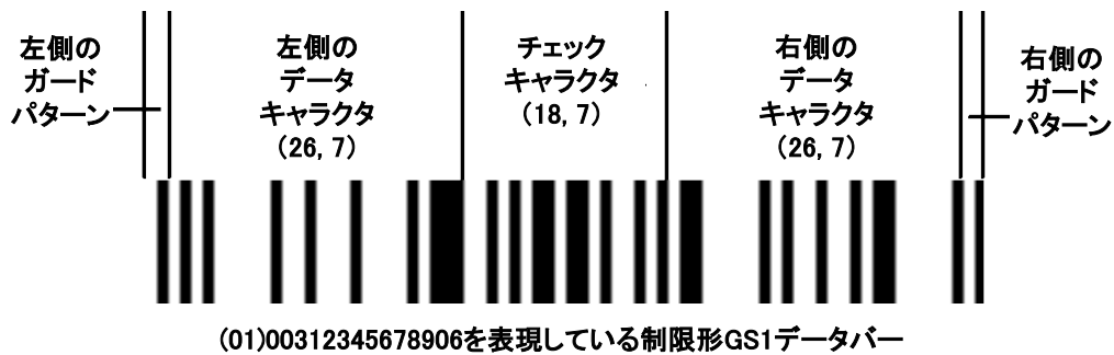
図 2-13 制限形 GS1 データバーの構成例
