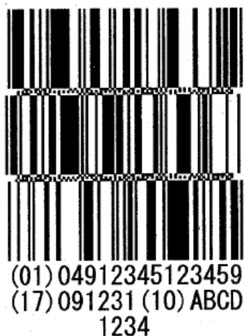
拡張形GS1データバーのシンボルを 分割して積み重ねたシンボル
