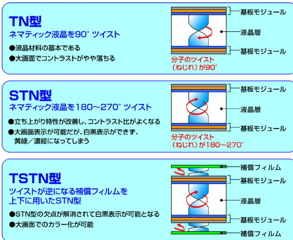
図 液晶構造の種類
