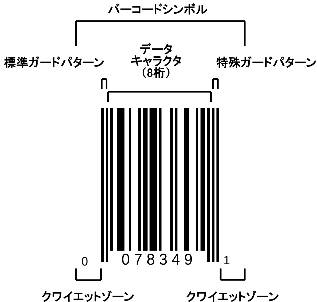
図2-8 UPC-Eの構成例
